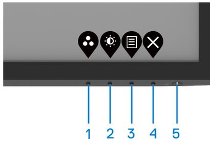
1. Halten Sie Taste 4 vier Sekunden gedrückt und ein Menü wird eingeblendet.
