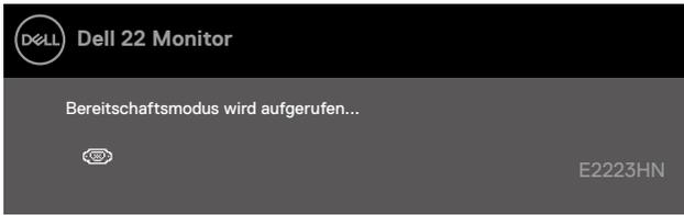
Ist das VGA- oder HDMI-Kabel nicht angeschlossen, erscheint ein schwebendes Dialogfenster. Der Monitor ruft nach 4 Minuten den Bereitschaftsmodus auf, wenn er in diesem Zustand belassen wird.
